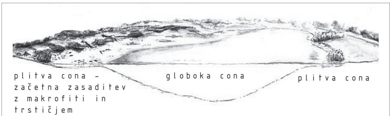
Slika 12: Prerez začetne faze vzpostavitve NH mokrišče (Wasserkraftwerke, 2008)
